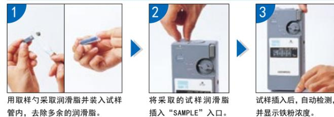
1. 用取样勺采取润滑脂并装入试样管内，去除多余的润滑脂。
