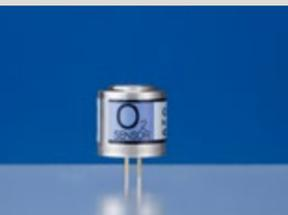
Ag 与 Pb 两极与气体一液隔膜、电解液构成了一个空气电池型的传感器。Ag 电极上的氧气发生反应，通过检测其电流变化测定气体浓度。
