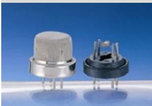
氧化锡粒子表面吸附的气体产生氧化反应及电气传导度的变化，对此变化进行测定。
