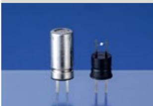
通过吸附在金属氧化物半导体表面的气体所产生的氧化反应以及电气传导度的变化，将该变化作为从铂丝线圈的两端所看到的电阻值变化，并由此对其进行测定。
