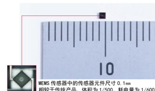
MEMS 传感器中的传感器元件尺寸 0.1mm
