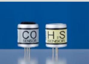
在特定的电位对气体进行电解，检测此时产生的电解电流，然后测定气体浓度。
