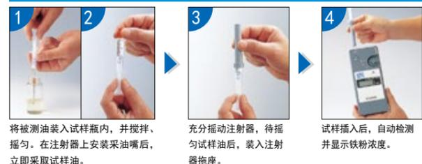
1. 将被测油装入试样瓶内，并搅拌均匀。在注射器上安装采油嘴后，立即采取试样油。
