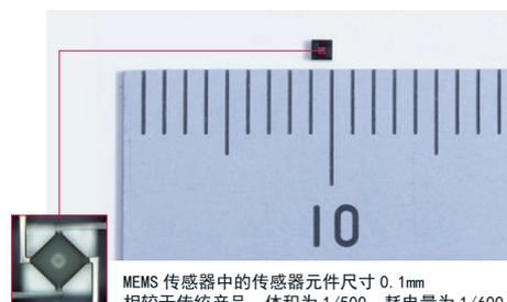
MEMS 传感器中的传感器元件尺寸 0.1mm
